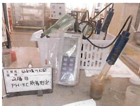
写真 簡易計測状況（2層目）
